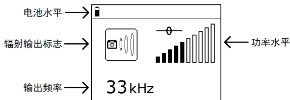
图 2-3-2 卡钳耦合输出界面显示
