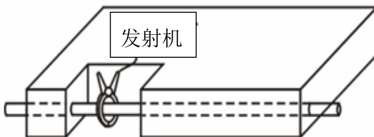
图4.7夹钳耦合法
